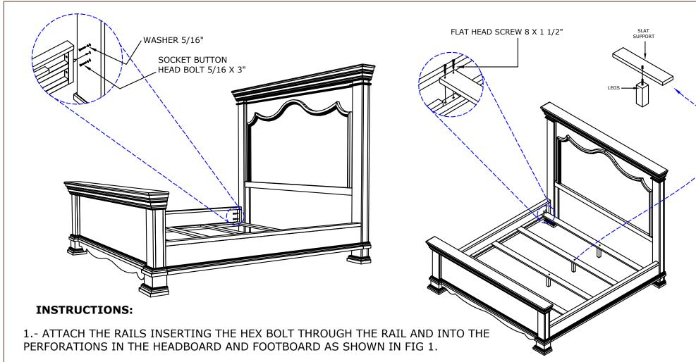
2.- ONLY THE FIRST SLAT (CLOSEST TO THE HEADBOARD) WILL BE SCREWED IN THE SLAT SECTION. FIG 2.
